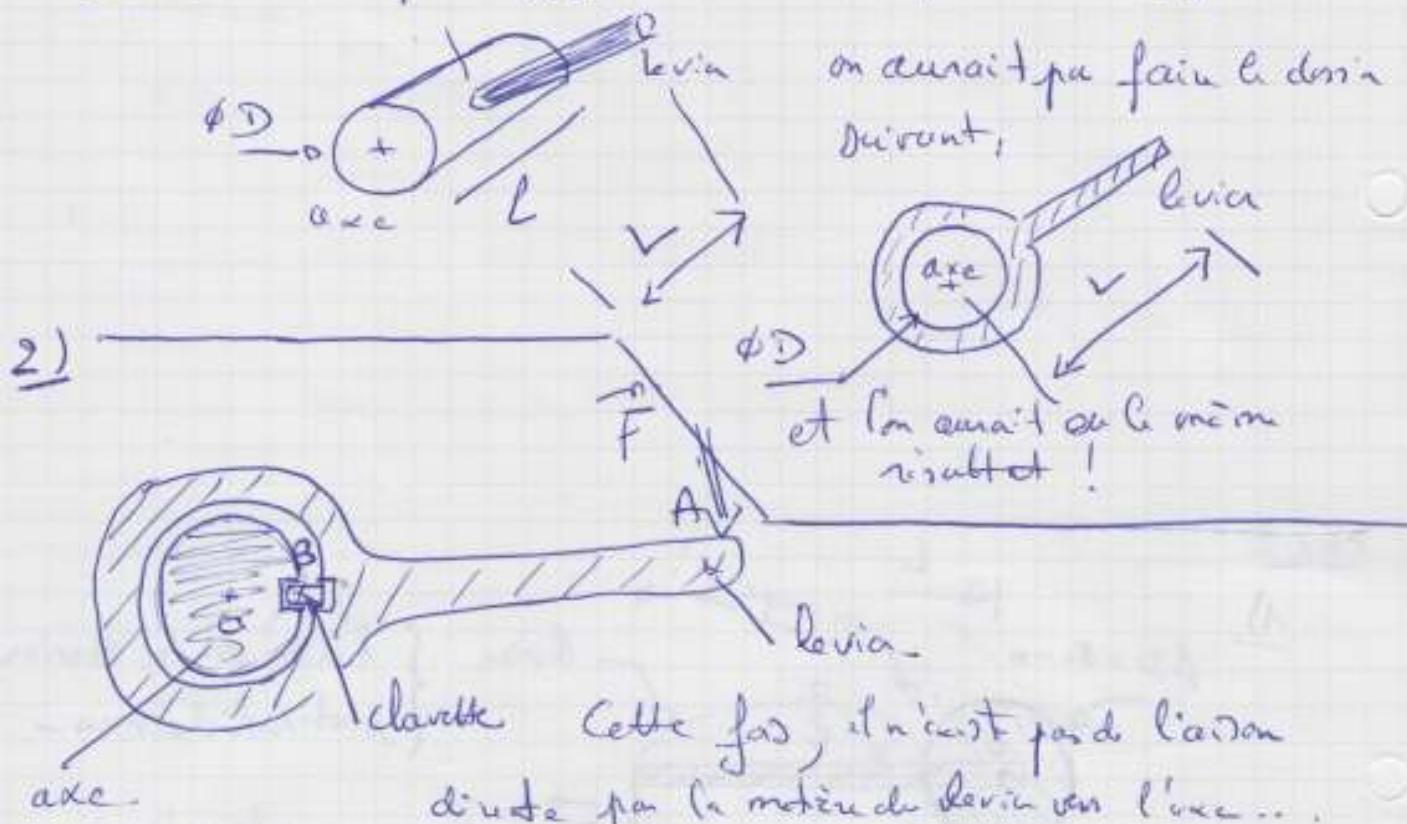
La clavette joue ce rôle, c'est donc elle qui transmet l'effet entre l'axe et le levier. C'est cette pièce que nous utiliserons pour résoudre le problème. Par contre, comme nous nous intéressons uniquement au mouvement de rotation, nous n'allons calculer que le moment lié à la force  $F$  et à l'antécédente de la clavette  $\tau_{\theta\theta}$ .
